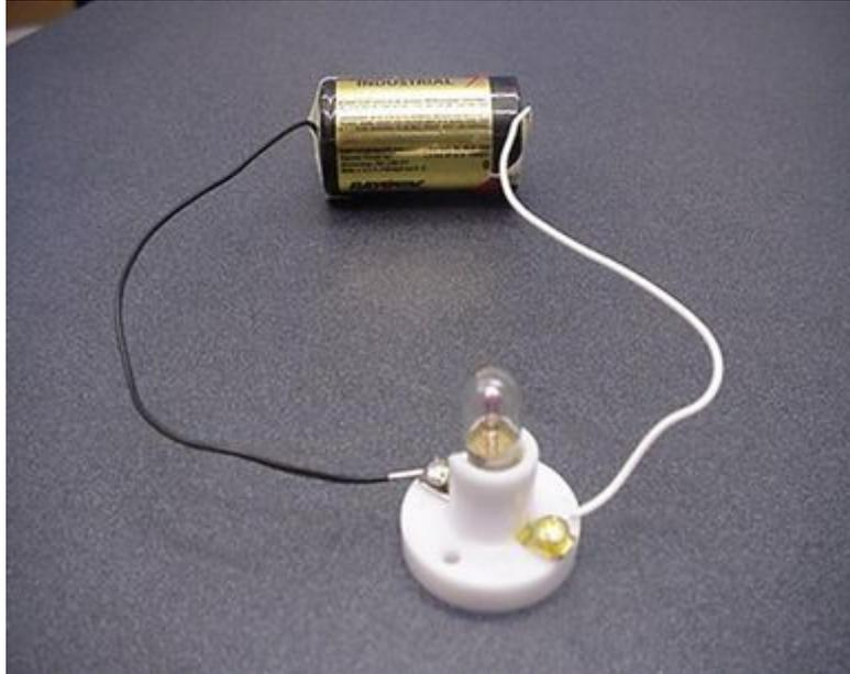
Per calcolare la potenza fornita dalla batteria basta fare il prodotto della tensione ai capi della batteria per la corrente che circola nel circuito. Supponendo per esempio che la batteria produca una tensione  $V = 3 \text{ V}$  e che la corrente misurata sia  $I = 0,5 \text{ A}$ , la potenza corrispondente è:
