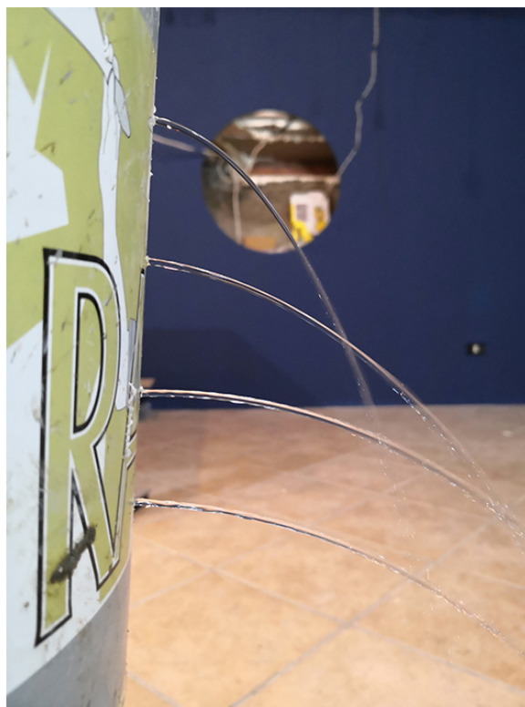
Figura 2: Principio di Torricelli: Flussi d'acqua
